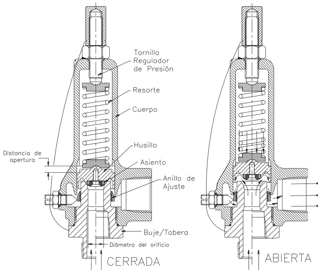
La válvula de seguridad y alivio Serie F80 de FLOW SAFE es una válvula de desahogo de acción directa accionada por un resorte, apta para el servicio de gas. El Tipo F84 tiene un asiento de plástico y el Tipo F85 un asiento de elastómero.
